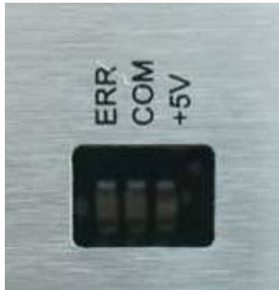
Abbildung 32: Status-LEDs „ERR“, „COM“ und „+5V“ auf PiXtend eIO Modulen
