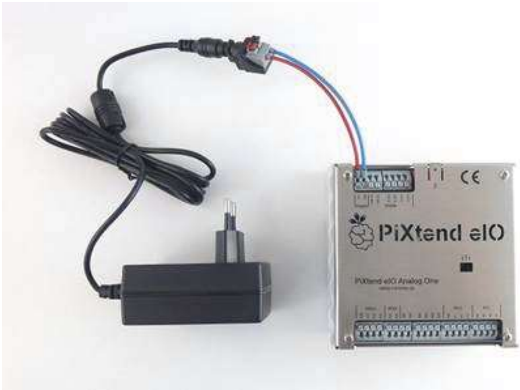
Abbildung 26: Anschluss des Netzteils an PiXtend eIO
